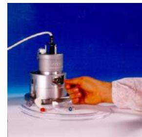
На рынок выпущена новая линия диспенсеров для растворителей. Ее основными инновационными характеристиками являются большая емкость резервуара для растворителя, которая составляет 850 мл, и система, которая позволяет устанавливать на держатель только определенные и утвержденные втулки.
