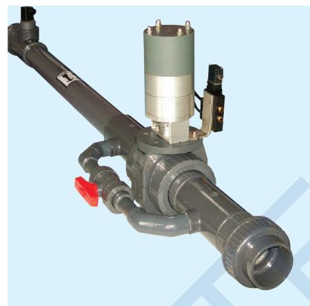
Для предохранения складских резервуаров при перекачивании из емкости поставки с использованием сжатого воздуха, Techap предлагает быстродействующий предохранительный заправочный клапан как комплектный блок (быстродействующий клапан вкл. управление, зонд и байпасный клапан с трубопроводами) с условными проходами DN 32, 40, 50, 65 и 80. Могут выбираться следующие материалы: PVC, PP, VA (1.4571) и St.37.
