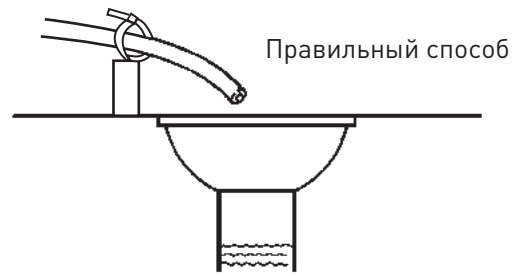
Рис. 6 – Соединение с дренажной линией
