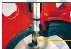
Соединение вала с диском с помощью четырехгранника
